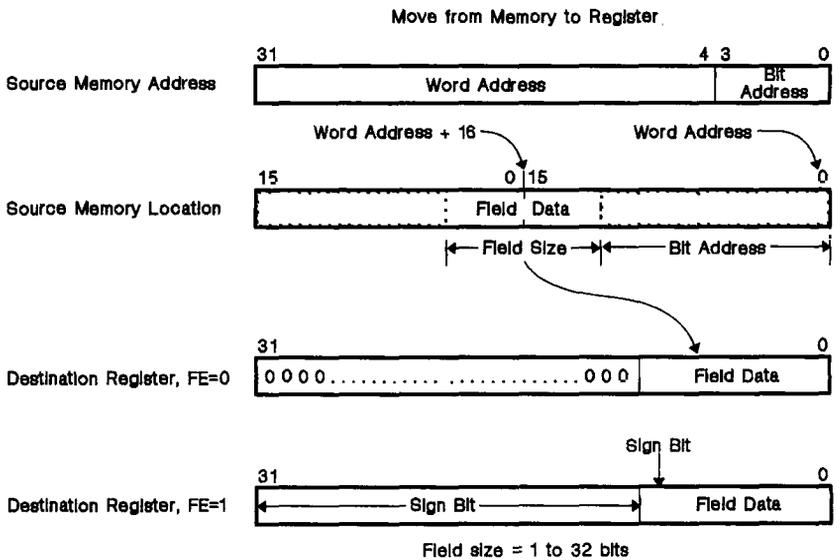
Figure 12-9. Memory-to-Register Moves
