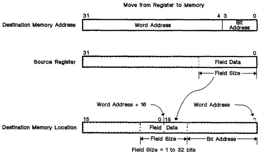
**Figure 12-8. Register-to-Memory Moves**
