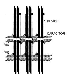
V<sub>CC</sub>, V<sub>SS</sub> GRID SHOWING DECOUPLING CAPACITORS
