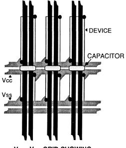
V<sub>CC</sub>, V<sub>SS</sub> GRID SHOWING DECOUPLING CAPACITORS
